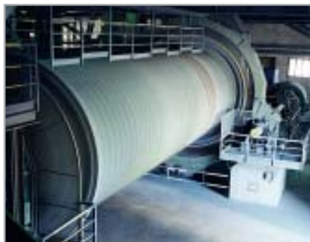
Примеры цементных мельниц с традиционными подшипниками.
