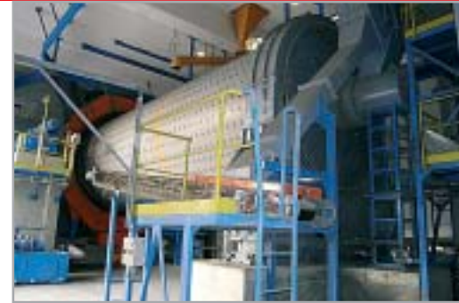
Цех помола цемента с мельницей Ø 4,0 x 13,75 м с посадкой на сегментных подшипниках
