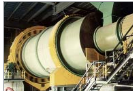
Мельница для помола сырья Ø 5,4x11 м с камерой сушки.
