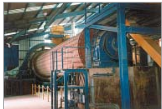
Примеры цементных мельниц с традиционными подшипниками.
