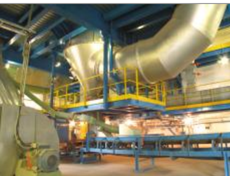
Odtahové potrubí produktu z třídíče a pas dopravy vratné krupice
