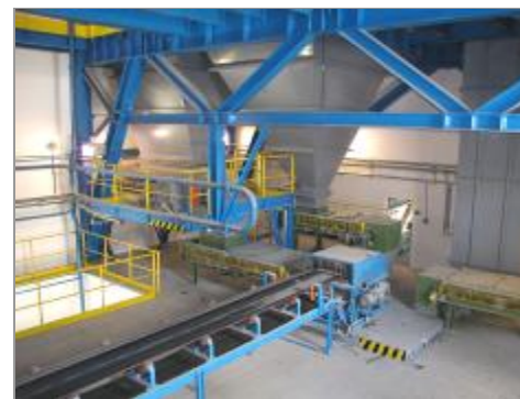
Dávkování komponent a vratné krupice do mlýna
