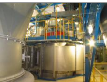
Spirální komora vzduchového třídíče
