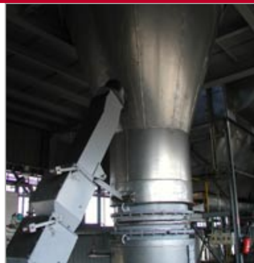
Воздушный сепаратор LTRR 1650 в цехе помола кокса 12,5 тн/час – OKD Ostrava, Чехия
