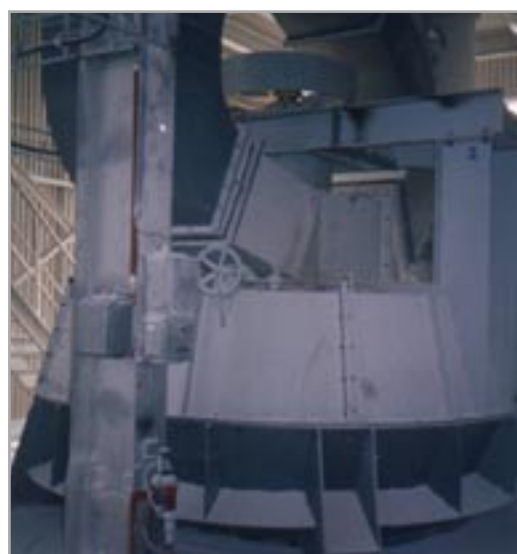
Воздушный сепаратор LTRR 2000 в цехе помола извести 36 тн/час – Завод Vitošov, Чехия
