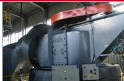
Воздушный сепаратор LTRR 1650 в цехе помола кокса 12,5 тн/час – OKD Ostrava, Чехия
