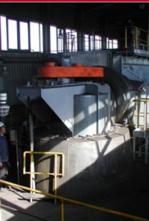
Воздушный сепаратор LTRR 1650 в цехе помола кокса 12,5 тн/час – OKD Ostrava, Чехия
