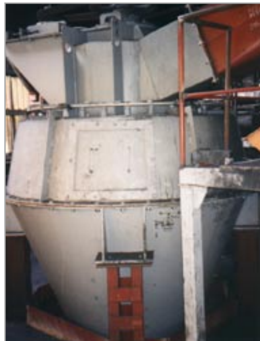
Воздушный сепаратор LTRR 1250M в цехе помола TiO 2 шлама 4,5 тн/час – Celje, Словения
