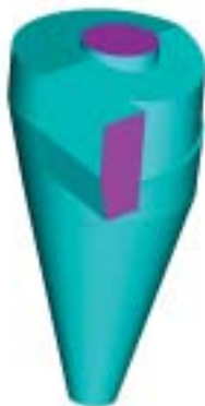
3D модель циклонов с высоким КПД для первой ступени системы.
