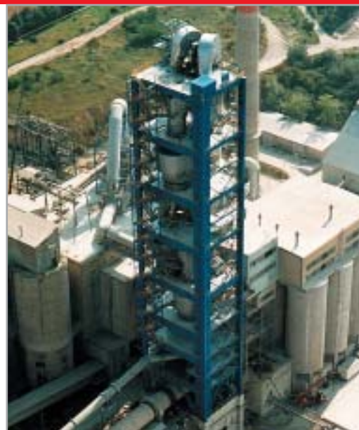
Теплообменник LUCY с системой декарбонизации KKN/AS в составе печной линии 2700 т/сутки
