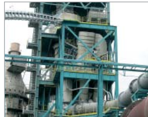
Камера декарбонизации с подачей твёрдых альтернативных видов топлива
