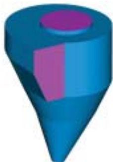
3D модель циклона с низкой потерей давления для нижних ступеней системы.
