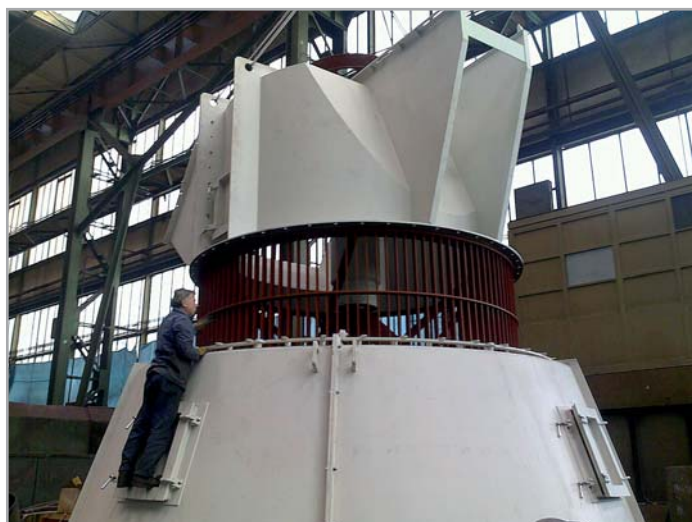
Контрольная сборка верхней части сепаратора мельницы
