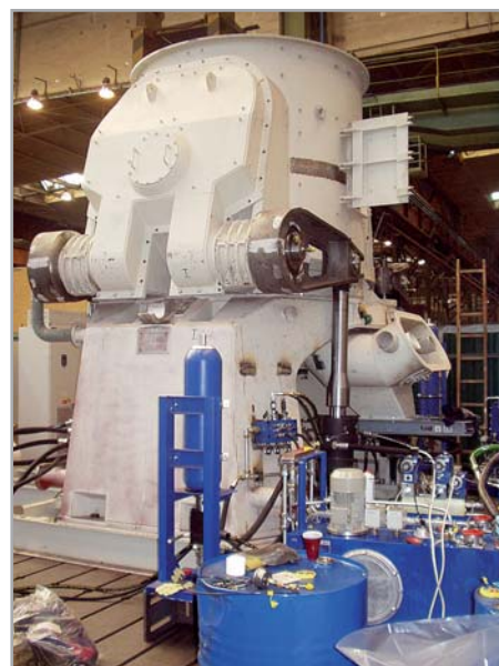
Сборка мельницы КТМУ 1800 для помола угля в цеху «PSP Engineering»
