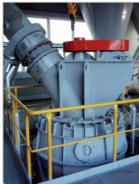
Сепаратор ДТМУ 1000 в помольном отделении угля
