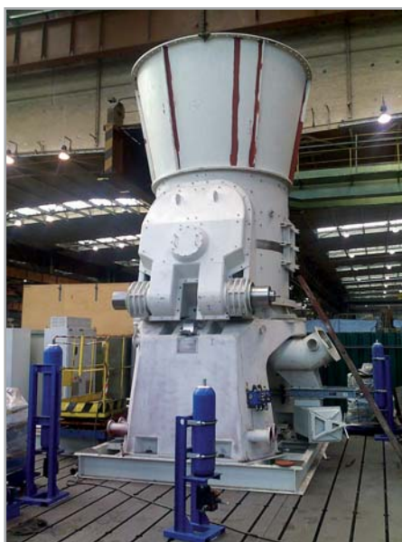
Сборка мельницы КТМУ 1800 для помола угля в цеху «PSP Engineering»
