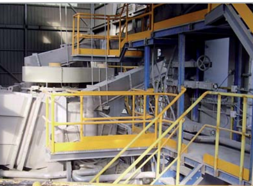
Сепаратор мельницы DTIM 2500 с подачей материала верхом
