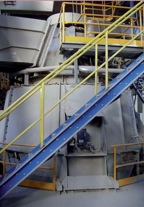
Сепаратор мельницы DTIM 2500 с подачей материала верхом
