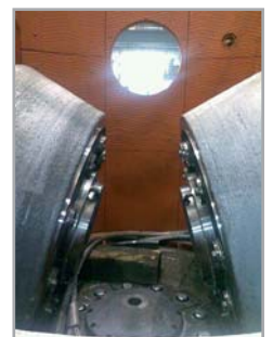
Мелющие бегуны и броньфутеровка мелющей камеры с износостойкой наваркой
